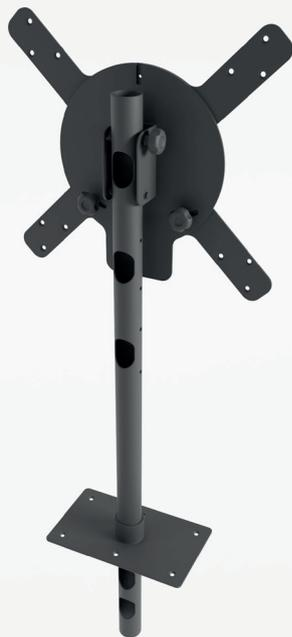
*Porta tv Ø 50 ad uso interno, girevole su bronzine in plastica con piastre e pomelli di regolazione. Prima si attacca la piastra VESA alla tv, poi il tutto si innesta al palo fermandolo con il pomello. Possibilità di poter ruotare su tre assi il televisore tramite regolazioni con pomoli.*
